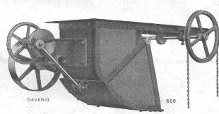
Automatischer Dosierungsapparat mit Sektorenverschluss. Maschinen und Apparate
