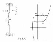
Vollständigkeitshalber möchte ich auch noch den Fall kurz erwähnen, wo der der Temperaturänderung ausgesetzte Stab nicht homogen ist, sondern auf entgegengesetzten Seiten verschiedene Ausdehnungs-Koeffizienten besitzt. In diesem Falle kann auch die stabile Gleichgewichtslinie
