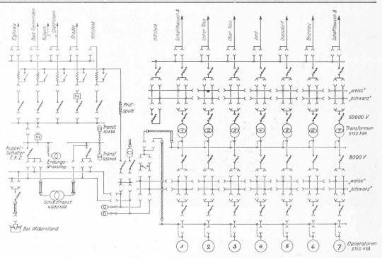
Abb. 48. Generelles Schema der Schaltanlage des Kraftwerks Eglisau.
