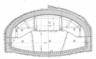
Abb. 39. Querprofil des Glattstollens mit eingezeichnetem Bauvorgang. Masstab 1: 120.
