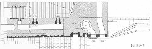
Abb. 36. Längs- und Horizontalschnitt durch die Schleuse in ihrem jetzigen ersten Ausbau. - Masstab 1:400.
