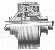
Benn-Kupplung, Typ NN, zur Verbindung zweier Wellen
