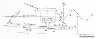
Fig. 2. Chambre d'équilibre raccordée au point de jonction de la galerie d'amenée et de la conduite forcée.
