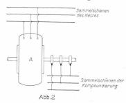
anstelle der Kompoundierungs - Sammelschienen dieses Schemas ein Anlasswiderstand, bezw. eine Kurzschluss - Vorrichtung angebracht wird, dann haben wir es mit dem gewöhnlichen, im Stator den Primärteil, im Rotor den Sekundärteil aufweisenden asynchronen Dreh-
