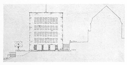
Querprofil des Geländes mit Profil der Villa und Nordostfassade. - Masstab 1:600.
