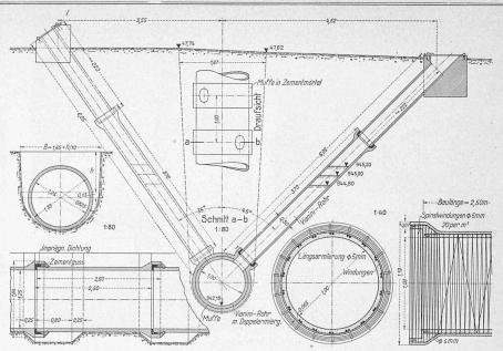
Abb. 28. Steigrohre zur Vornahme von Wassermessungen. - Masstab 1:80. bezw. 1:40.
