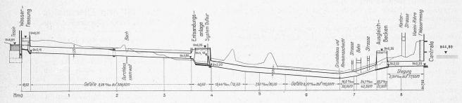
Abb. 24. Längenprofil des Zuleitungskanals vom Tessin bis zur Pumpenanlage. – Masstab der Längen 1:5000, der Höhen 1:500.
