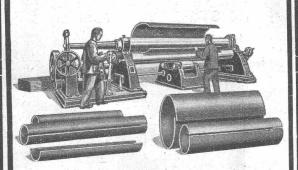
Dreiwalzen Blech-Rund-oder Biegemaschine zum zylindischen und konischen Einrollen von Kesselschüssen, Rohren. Behältern us.w. für Bleche bis zu 25mm Dicke bei 4000mmgröhter Breite, mit maschineller Höhenverstellung und Kippvorrichtung der Oberwalze.
