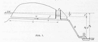
Um Gleichung (5) auf die Form der Gleichung (1) zu bringen, wird das Störungsglied durch die bekannte Axen-Transformation mit  $z = z_0 + s$  beseitigt, wobei  $z_0$  den Abstand der Schwingungsaxe vom Weiherspiegel bedeutet. Damit ergibt sich unter Vernachlässigung der Glieder in s von höhern als zweiter Ordnung
