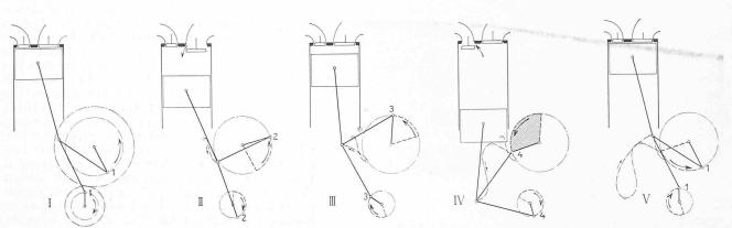
Viertaktmotor von Andreau mit ungleichen Hüben. - Schematische Darstellung der einzelnen Kolben-Endstellungen.
