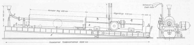
Abb. 2. Röhren-Schleudergiessmaschine nach System Arens, gebaut von den L. von Roll'schen Eisenwerken. - Längs- und Stirnansicht 1:70.
