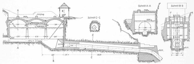
Abb. 23. Längsschnitt und Querschnitte durch das Wasserschloss und den anschliessenden Rohrstollen. — Masstab 1:400.
