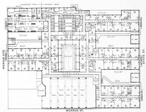
Abb. 4. Grundriss des sechsten Geschosses des Palmerhouse. — Masstab etwa 1:800.
