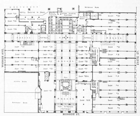
Abb. 2. Grundriss vom Erdgeschoss des Palmerhouse in Chicago. — Masstab etwa 1:800. An den Strassenfassaden und an den innern Arkaden, die die drei Strassenfronten verbinden, liegen lauter Ladengeschäfte, an ihrer Kreuzung die Gruppen der Personen- und Dienstaufzüge.
