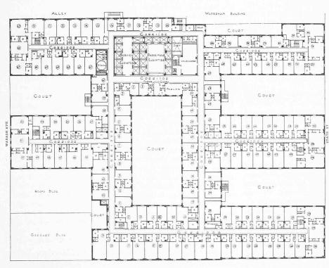
Abb. 5. Grundriss eines typischen Hotelgeschosses (10. bis 23. Geschoss). — Masstab etwa 1:800.
