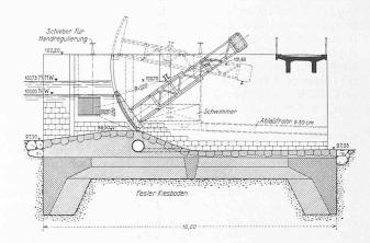
Abb. 4. Schnitt durch das Wehr bei Radin. — Masstab 1:200. Automatische Segmentschützen System Stauwerke A.-G., Zürich.
