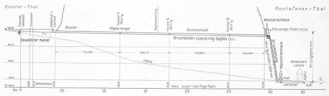
Abb. 10. Längenprofil des Alfenz-Werkes. - Längen 1:20000, Höhen 1:2000.
