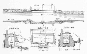
Abb. 16. Ueberlauf und Leerlauf. - Masstab 1:300.
