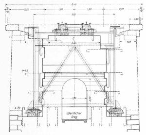
Abb. 8. Bauvorgang der Fahrbahnrekonstruktion. - Querschnitt 1:100.
