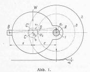
der Formeln nehmen wir an, dass der Drehpunkt B während des Stosses in Ruhe bleibe, was sehr angenähert stimmt, wenn der Motor wenigstens in der Nähe des theoretisch günstigsten Punktes aufgehängt ist, weil dann eine allfällige Stossreaktion in diesem Punkt nur klein, und die Fahrzeugmasse, die sie aufnimmt, verhältnismässig gross ist. Die Beschleunigung  $a_3$  des Punktes C ist
