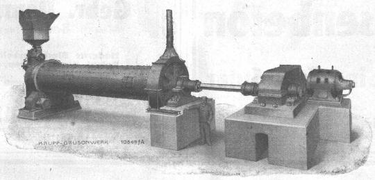
Mehrkammer-Verbund-Rohrmühle mit Centra-Antrieb
