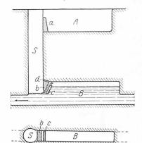
schwelle a der obern Kammer (siehe nebenstehende Abbildung), durch die die Wassersäule und damit das Druckgefälle von vornherein um dieses Mass höher wird. Damit sind auch entsprechende Raumeinsparungen bedingt. Eine ähnliche (zum Patent angemeldete) Vorrichtung ist die in der untern Kammer eingebaute sogen. Saugschwelle b. Die Wirkungsweise liegt darin, dass bei vermehrtem Wasserbedarf eine rasche Spiegel-
