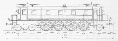
Abb. 3. Schnellzuglokomotive, Typ 2-A<sub>4</sub>-1, für die Schweizerischen Bundesbahnen. — 1:150.
