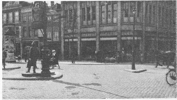
Abb. 12. Im Haag: Links erhöhter, fester Standpunkt für den Signalisten; rechts kleine Dreieckinsel, nicht rund und indifferent, sondern durch gerade Kanten richtungweisend.
