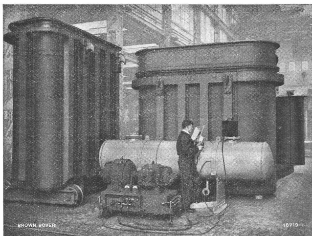
Mit Brown Boveri Lichtbogen-Schweißgruppen elektrisch geschweißte Groß-Transformatorenkessel.
