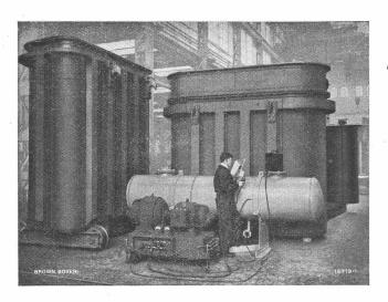
Mit Brown Boveri Lichtbogen-Schweißgruppen elektrisch geschweißte Groß-Transformatorenkessel.
