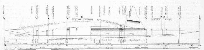
Abb. 2. Längenprofil zum Z.I.A. Projekt vom März 1901 für eine Tiefbahn auf bestehendem Tracé, vorläufig bis Enge. Darüber (gestrichelt) Hochbahn Projekt N.O.B. — Längen 1:18000, Höhen 1:900. — Aus der "S. B. Z." vom 30. März 1901.
