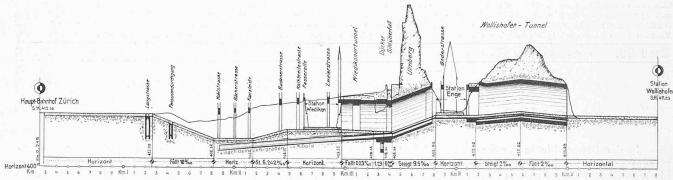
Abb. 3 Längenprofil der umgebauten "Linksufrigen". — Masstab für die Längen 1:30,000, für die Höhen 1:750.
