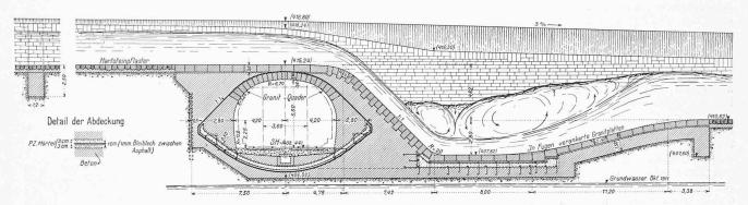
Abb. 4. Schnitt durch die Unterfahrung des verlegten und gehobenen Sihlflusses. - Masstab 1:300.
