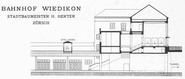
Abb. 28. Längsschnitt in Bahnaxe. - Masstab 1:500.
