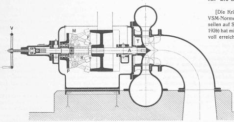
Abb. 1. Selbstregulierende Turbine, Bauart Crozet-Fourneyron, für Riemenantrieb. - Schnitt 1:20.
