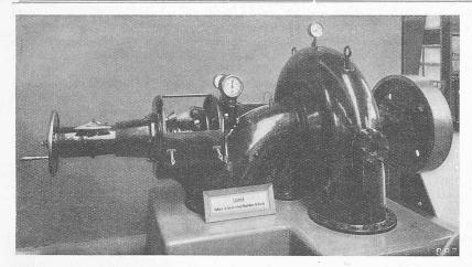
Abb. 2. Selbstregulierende Turbine, Bauart Crozet-Fourneyron, für dizekte Kupplung.
