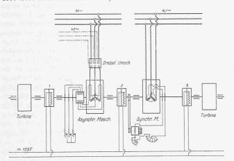
Abb. 3. Schaltungschema der Anlage Predaro. 1, 2, 3 Elektromagn. Kupplungen.
