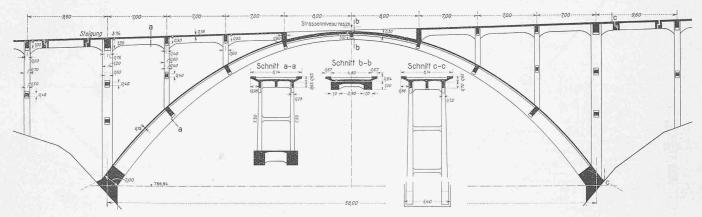
Abb. 2. Längsschnitt und Querschnitte. - Masstab 1:400.
