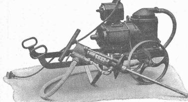
durch elektrisch-pneumatische Fein - Hammer - Anlagen mit Bohr- und Meissel-Pistolen
