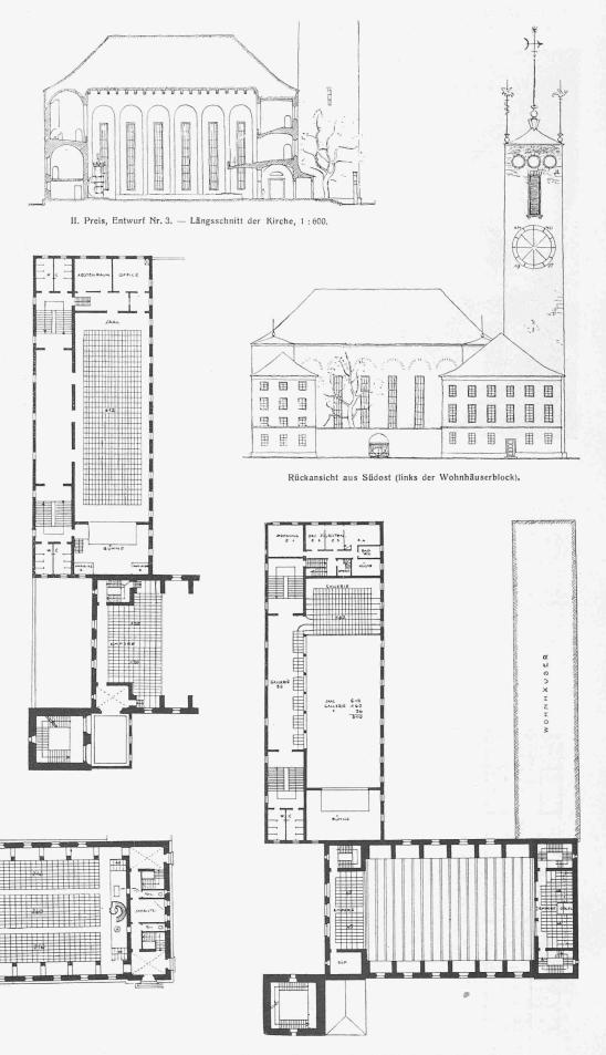
II. Preis, Entwurf Nr. 3. - Architekten Moser & Kopp in Zürich. - Grundrisse vom Erdgeschoss, I. und II. Stock. - Masstab 1:600.
