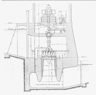
Abb. 15. Kraftwerk mit EWC-Propeller-Turbine in Kanada. - 1:300.
