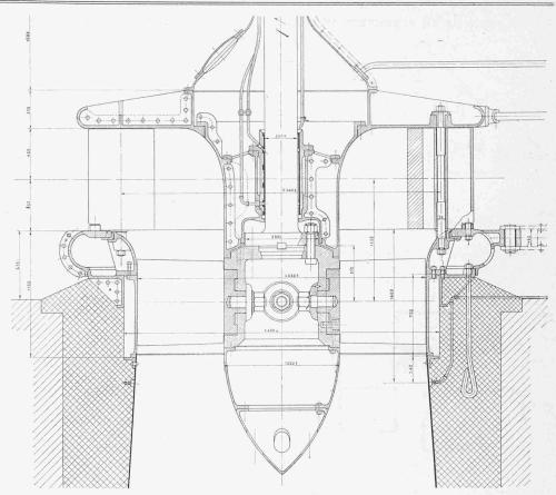
Abb. 16. Vertikalachsige Propeller-Turbine für 3500 PS, H = 9,15, n = 180 Uml/min der nebenstehenden Anlage. - 1:35.
