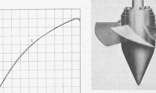
50 Abb. 9. Propeller-Turbine mit 6 Schaufeln. Wirkungsgrad in Funktion  $N_e$  bei  $n_s=640$ .
