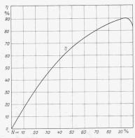
Abb. 10. Propeller-Turbine mit 8 Schaufeln Wirkungsgrad in Funktion Ne bei ns = 570.
