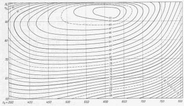
Abb. 12. Hauptcharakteristik der Propeller-Turbine mit 6 Schaufeln.
