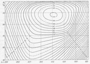
Ahb. 11. Hauptcharakteristik der Propeller-Turbine mit 4 Schaufeln.
