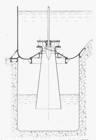
Abb. 1. Propeller-Turbine in der Versuchsanstalt Zürich von EWC.
