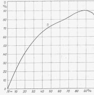
Abb. 8. Propeller-Turbine mit 4 Schaufeln. Wirkungsgrad in Funktion Ne bei ns = 420.
