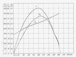
Abb. 5. Propeller-Turbine mit 4 Schaufeln. Charakteristische Kurven in Funktion der Drehzahl für H=1 m.
