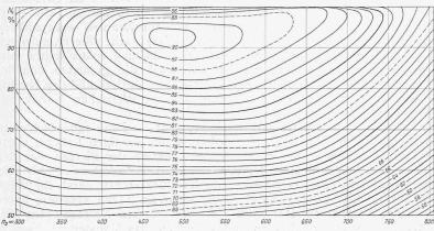
Abb. 13. Hauptcharakteristik der Propeller-Turbine mit 8 Schaufeln.
