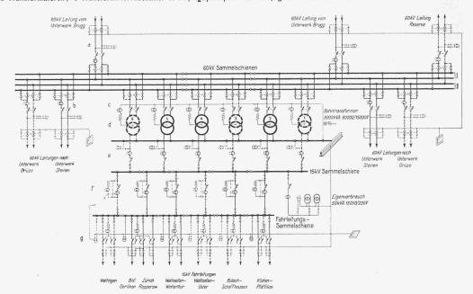
Abb. 5. Schaltungschema der Freiluftanlage des Unterwerkes Seebach der S.B.B.
