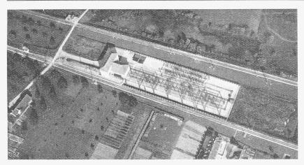
Abb. 2. Fliegerbild des Freiluft-Unterwerkes Seebach der S. B. B., aus Westen.
