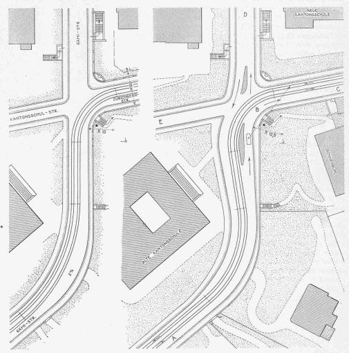
Abb. 5 (links). Jetziger Zustand. — Masstab 1:1000. — Abb. 6 (rechts). Verbesserungs-Vorschlag unter Schonung der prachtvollen Baumgruppe: Statt harter Kreuzung weiche Biegung und Verzweigung, flüssige Linien.
