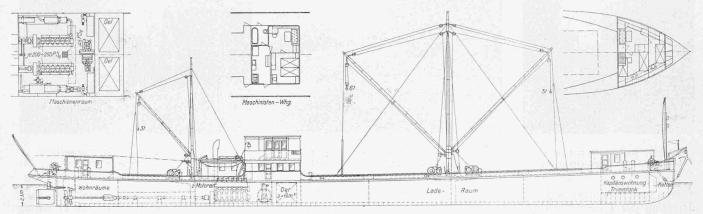
Abb. 2. Längs- und Horizontalschnitte des Eilgüterbootes "Jupiter". - Masstab 1:350.
