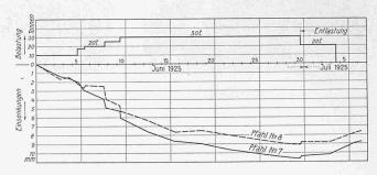
Abb. 7. Diagramm der Belastungsproben.
