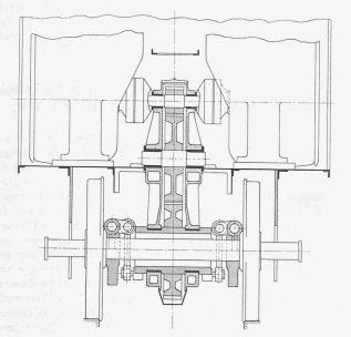
Einzelachsantrieb mit zentralem Doppelvorgelege. — Masstab 1:40.
