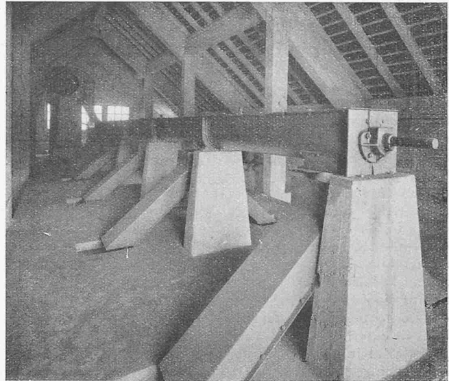
Abb. 3. Verteilungsschnecke im Dachboden. Im Hintergrund der Elevator.
