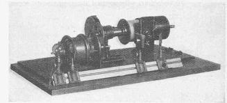
Abb. 3. Sender für drahtlose Bildschnelltelegraphie, System Karolus-Telefunken. - Abb. 4. Empfänger.
