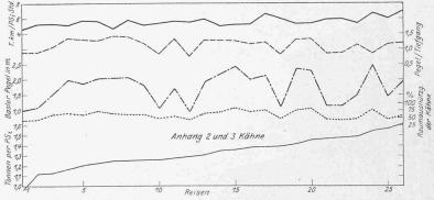
Abb. 9. Traktionsverhältnis eines Seitenraddampfers von 1,15 m Tiefgang, 72,00 m Länge zw. d. L., 9,10 m Breite, 20,00 Breite über Räder, 1100 PSi. Kurven von oben nach unten: Schleppleistung in tkm/PSih; Pegel/Tiefgang; Basler Pegel; Raumausnutzung der Kähne; Schlepplast in t/PSi.
