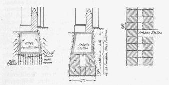
Abb. 15. Fundament-Unterfangung am Mainzer Dom. -1:250.
