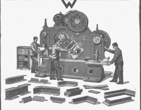
Vereinigte Lochstanze, Blech-u. Profileisenschere in Stahlformguss
