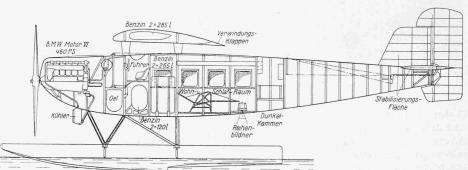
Abb. 2. Längsschnitt durch das Flugzeug. — Masstab 1:100. Spannweite des Flügels 19,50 m; gesamte Flügelfläche 62 m²: Breite der Kabine 1,45 m; Leergewicht 2200 kg.
