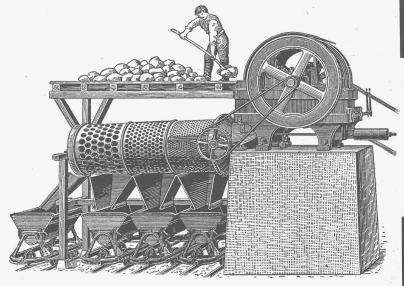
Steinbrecher mit Sortiertrommel.
