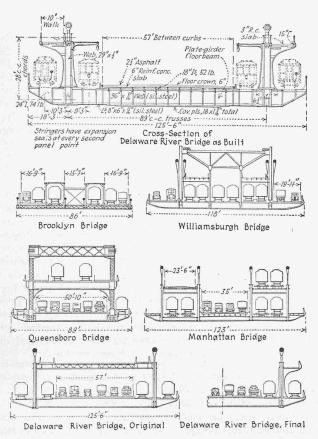
Abb. 2. Oben Querschnitt 1:500 der neuen Delaware-Brücke;
