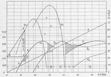
Abb. 1. Kurven der Wassermenge Q, des Wirkungsgrades  $\eta$  und des Ausdrucks  $\varphi = \eta + Q d \eta / d Q$ für zwei Propellerturbinen: a) mit  $n_s = 600$  und für  $Q_{\text{max}} = 28,5 \text{ m}^3/\text{sek}$ ,
