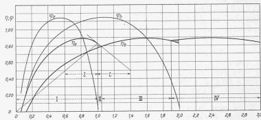
Abb. 3. Kurve für den Wirkungsgrad  $\eta$  und den Ausdruck  $\varphi=\eta+QJ\eta/dQ$ für zwei Francisturbinen mit  $n_s=200$ , davon b für die doppelte Wassermenge wie a. Zonen I und II: Turbine a allein, in Zone II mit sehr kleinem Ueberschuss arbeitend. Zone III: Turbine b allein.
