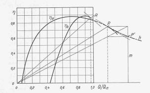
Abb. 2. Wirkungsgradkurven einer Francisturbine a mit  $n_s = 200$ und einer Propellerturbine b mit  $n_s=700$ , beide gleicher Leistung. Bei a liegt der Punkt P grösster Leistung ausserhalb der Zone der Ausnützung, bei b Punkt R innerhalb davon. - b dürfte daher nicht über die R entsprechende Wassermenge geöffnet werden.
