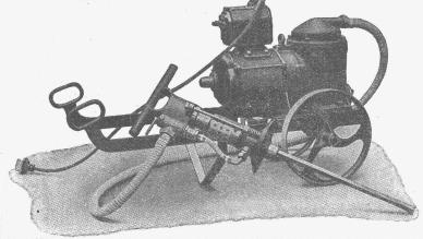
durch elektrisch-pneumatische Fein - Hammer - Anlagen mit Bohr- und Meissel-Pistolen
