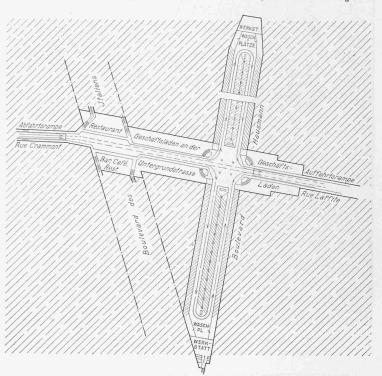
Abb. 6. Vorschlag für eine Untergrund-Garage in Paris unter dem Schlusstück des Boulevard Haussmann beidseits der Rue Laffitte. — Masstab rund 1: 3200.
