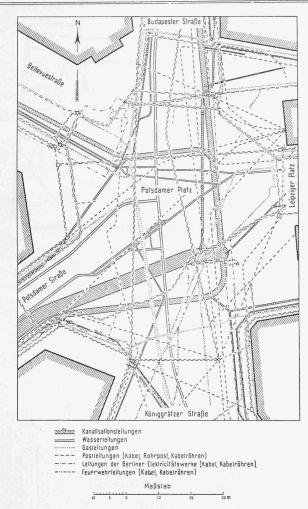
Abb. 1. Der Potsdamerplatz in Berlin mit seinen unterirdischen Leitungsnetzen.
